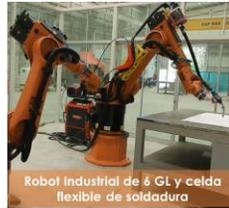
Robot Industrial de 6 GI y celda flexible de soldadura
