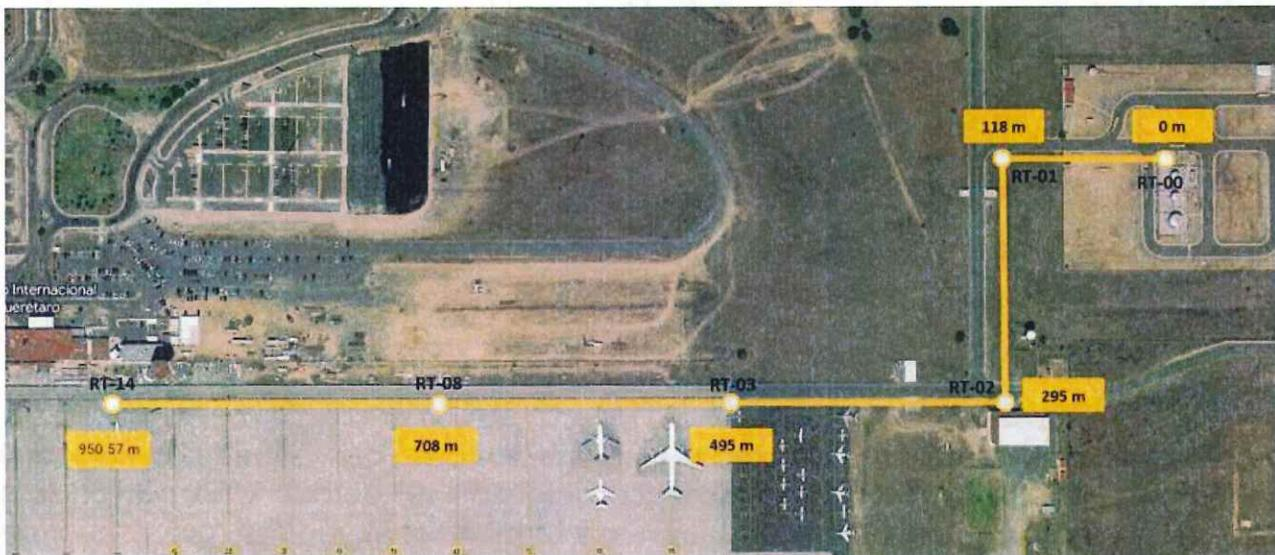
Figura 3. Longitud de red de hidrantes con ubicación de registros
