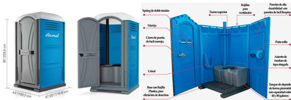
Figura 37. Diagrama y características de sanitario portátil para manejo de aguas sanitarias en obra.
